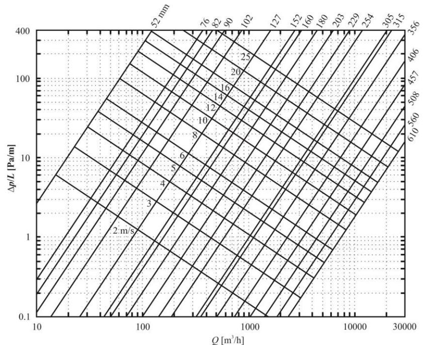
Die **CONNECTDEC TYP NON-WOVEN 50 PE SCHWARZ** Schläuche erfüllen alle Anforderungen spezifiziert in EN 13180: „Lüftung von Gebäuden - Luftleitungen - Maße und mechanische Anforderungen für flexible Luftleitungen“
